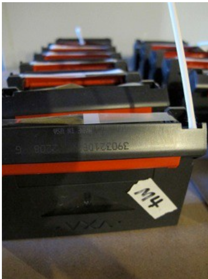
Una cinta de datos VXA con un identificador de recuperación, con la intención de unirla con su caja (marcada con el mismo identificador) después del secado.
